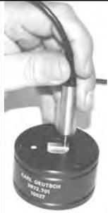
**Nullfeldkammer:** Einsetzen der Sonde, dabei korrekte Ausrichtung der Sonde beachten (die Unterseite weist in Richtung des Markierungspunkts).
