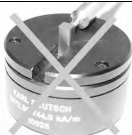
**Sonde nicht mit der Stirnseite nach unten positioniert.**
