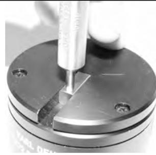
**Referenzmagnet:** Korrekte Messposition der Sonde bei der Referenzmessung: Nur bei gleichbleibender Messposition können reproduzierbare Messwerte ermittelt werden.
